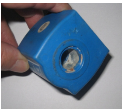
Furo central sem oxidação
